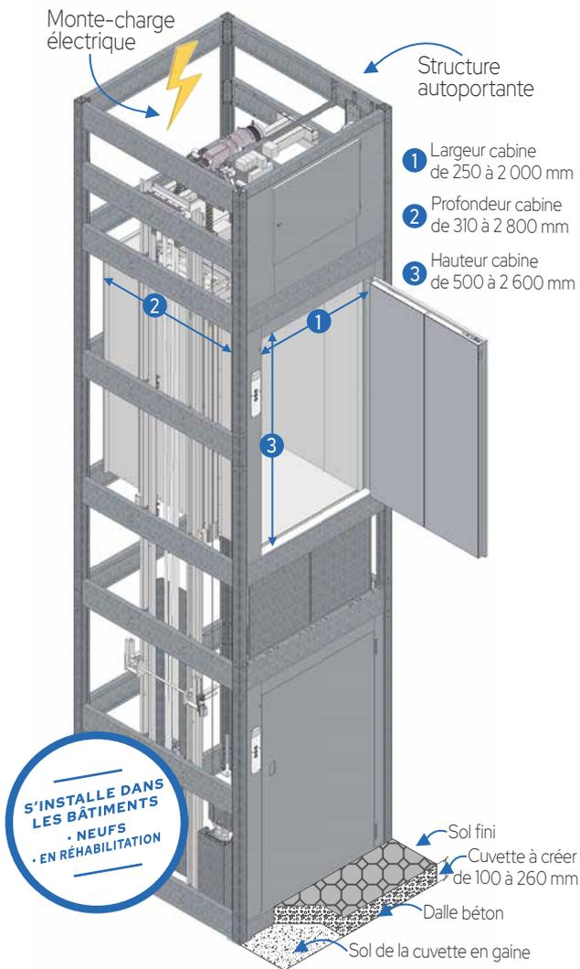
Conforme aux normes EN81-3 et EN81-31 / directive machine 2006/42/CE
